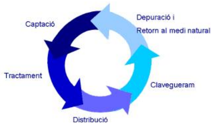
Figura 4. Diagrama representatiu del cicle urbà de l'aigua.
