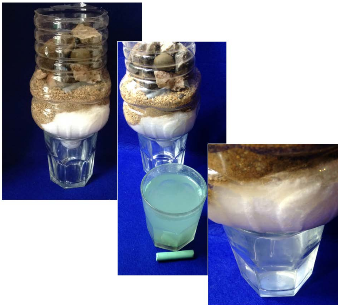
Figura 39. Exemple de sistema de depuració casolà.
