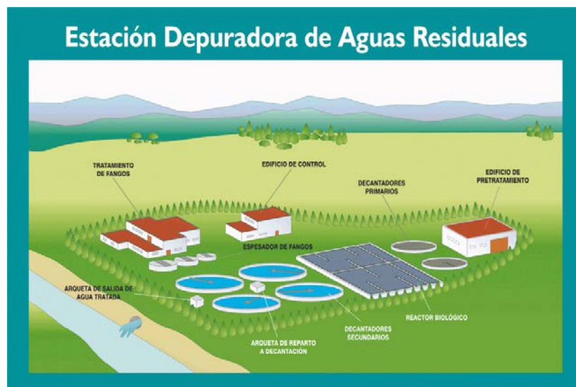
Figura 40. Depuradora, estructures i funcions de la planta.
